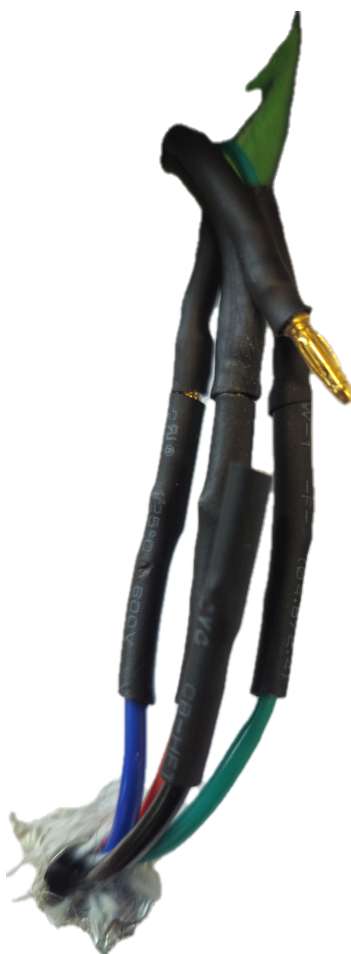
Joonis 3.2.5. Bullet connector ühendused mootorite ja draiverite vahel
