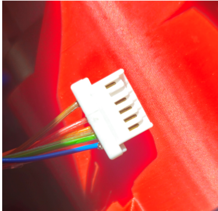
Joonis 3.2.8. Kodeerijad jaoks loodud Molex ühendus. Pruun: CS viik, punane GND, sinine 5V, roheline DATA, oranž CLK.
