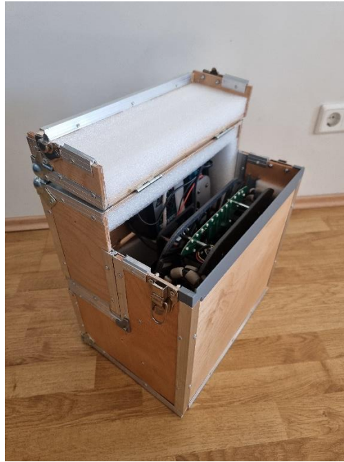
Joonis 24. (a) Transpordikest koos akulaadijaga, (b) Transpordikasti küljeprofiil, (c) Robotont laadimisjaamas, (d) Suletud asend, (e) Transpordikast tuulutusasendis.
