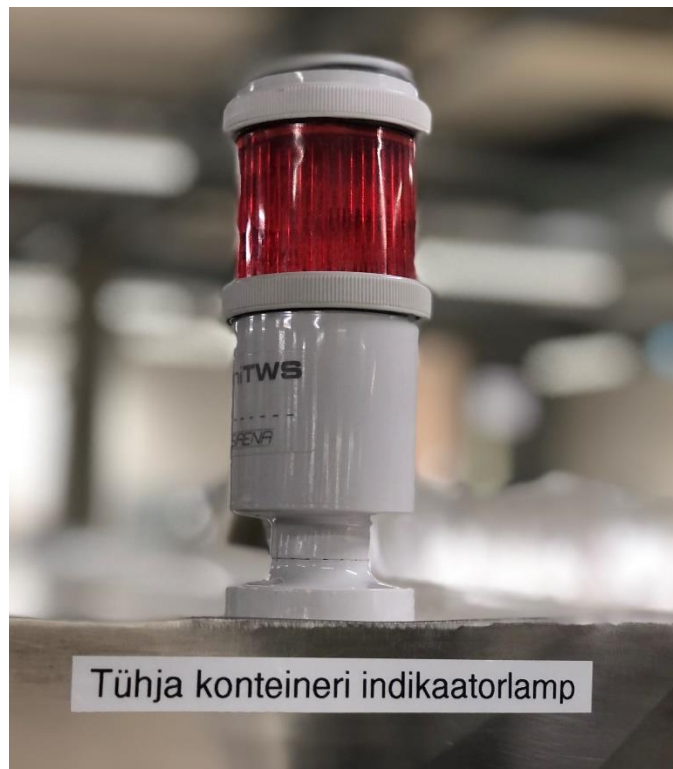
Joonis 12. Tühja konteineri indikaatorlamp
