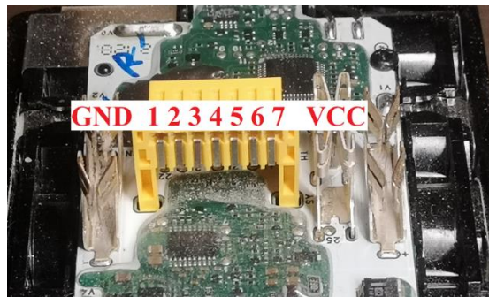
Joonis 10. Makita BL1850B BMS koos laadimiskontaktide ja andmesuhtluspistikuga.
