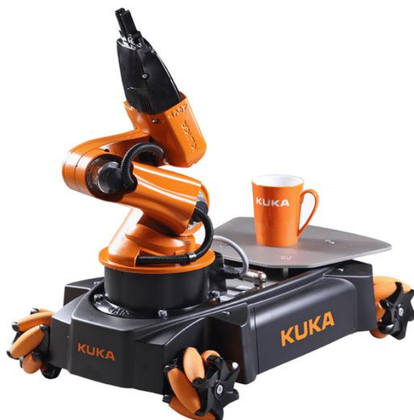
Joonis 2.9. Mekaanumratastega Kuka Youbot robotkäega [25].
