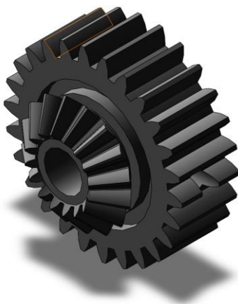
Koonushammasratas 1M 16GT 16PT ühendatuna silinderhammasrattaga 1M 26T mudel.
