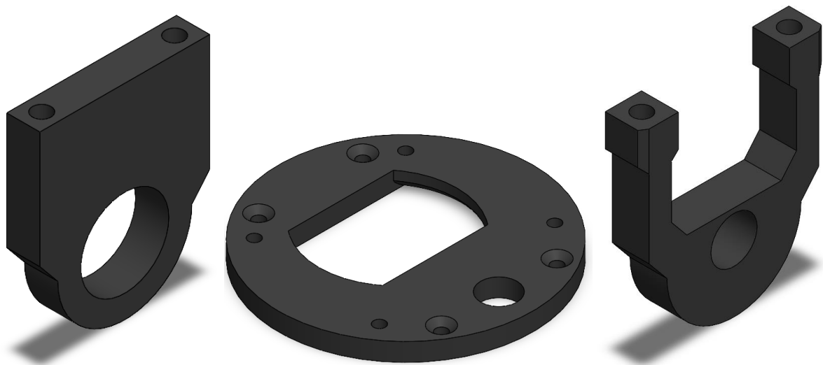
Rattahoidja keredetailid osadeks lahutatuna mudelid.
