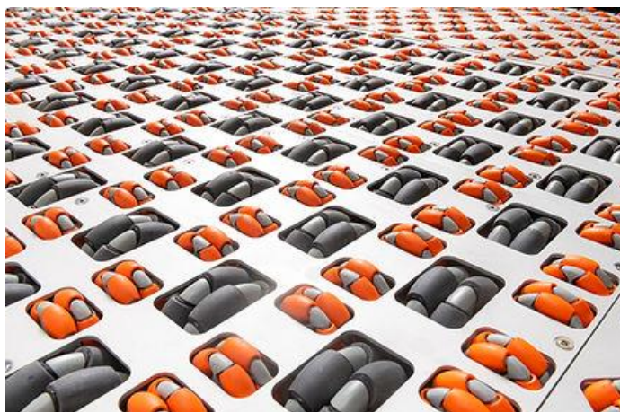
Joonis 2.5. Omniratastega sorteerimislint. [19]
