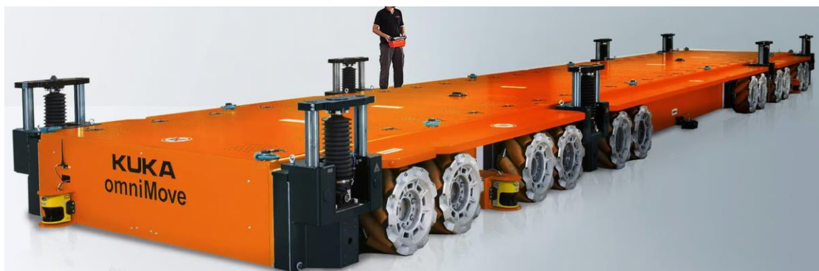
Joonis 2.8. Mekaanumratastega raskete vedude platvorm [24].
