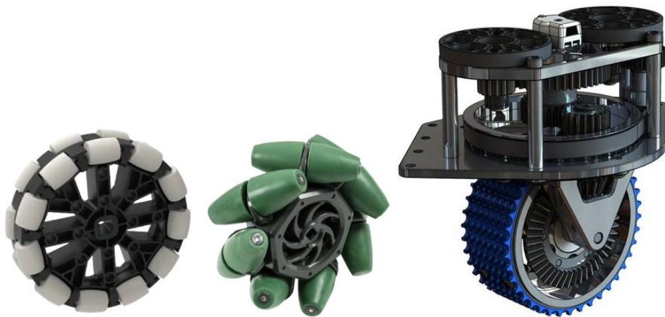
Joonis 2.1. Pildid erinevatest omniliikumisel kasutatavatest ratastest. [13] [11]
