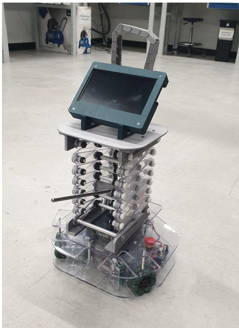
Joonis 5.2. Valminud tõstemehhanism Robotondi peal.
