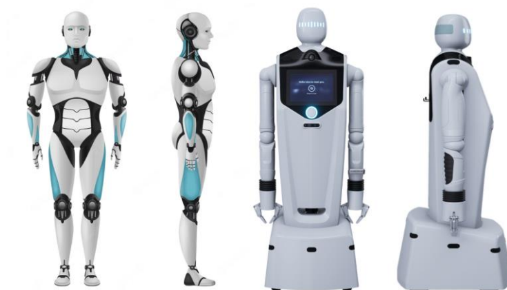
Joonis 3.3: Kahejalgne robot vs robot ratastel [9]
